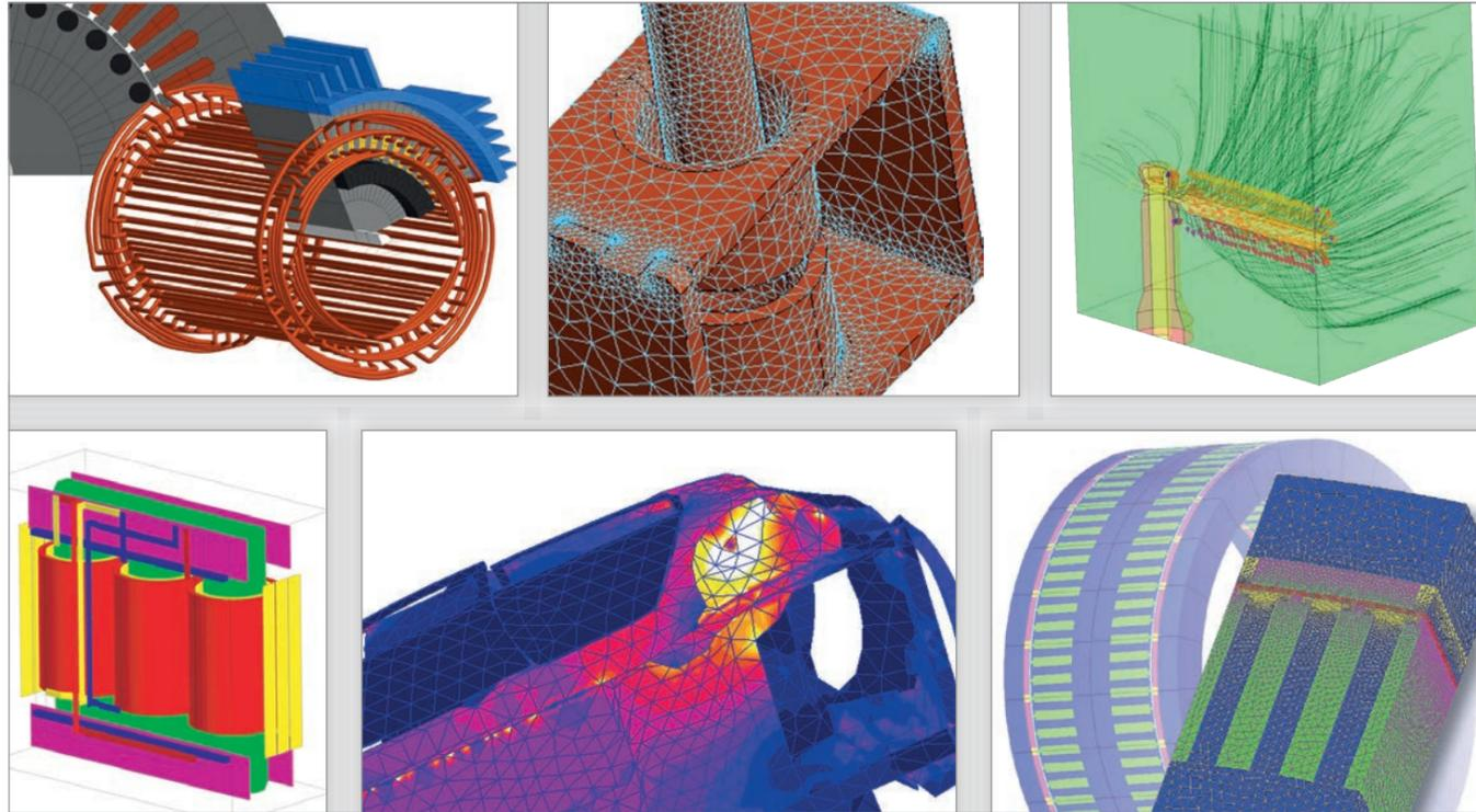
플럭스는 2D, 3D 및 스큐(Skew) 영역에서 저주파 전자기 및 열 해석 솔루션을 제공하는 유한요소 기반의 혁신적인 전자기 분석 소프트웨어입니다. 전 세계적으로 설계 프로세스 최적화 및 출시 기간 단축이 큰 이슈인 상황에서, 플럭스는 개방적이고 사용하기 쉬운 인터페이스로 지난 35년간 산업을 선도하는 첨단 전자기 시뮬레이션을 제공하고 있습니다. 플럭스는 알테어의 다른 소프트웨어와 쉽게 커플링을 할 수 있어 멀티피직스 해석에 용이하여, 장치 및 시스템을 가장 정확하게 해석할 수 있습니다.
